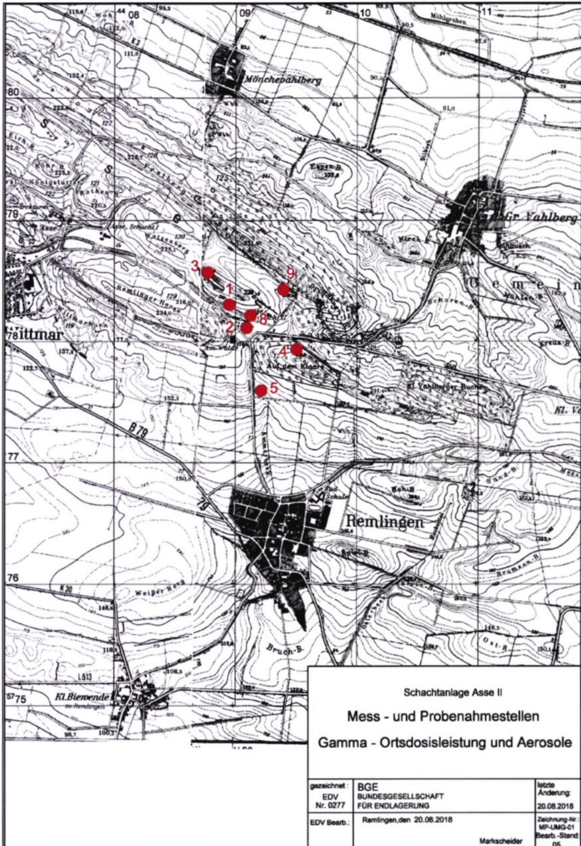
Abbildung 6: Mess- und Probenahmestellen für Gammastrahlung und Aerosole
